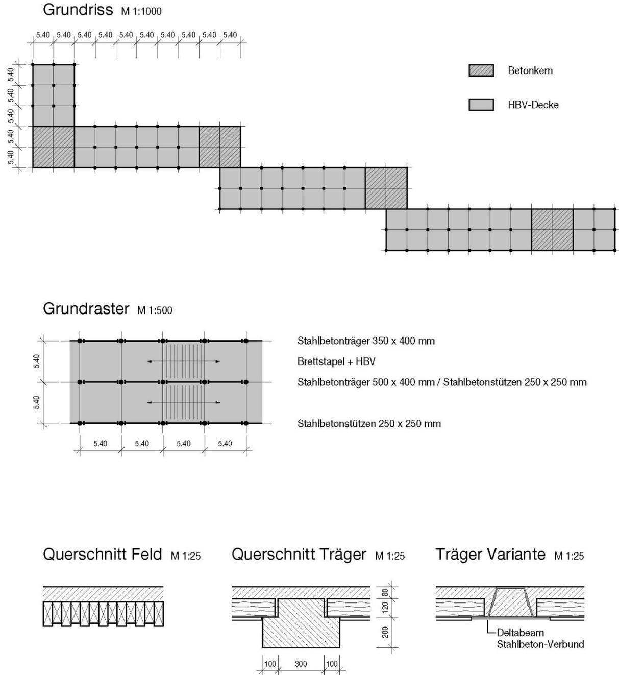
Abbildung 5: Gewerbepark Gebenloo: Grundriss, Grundraaster und Querschnitte
