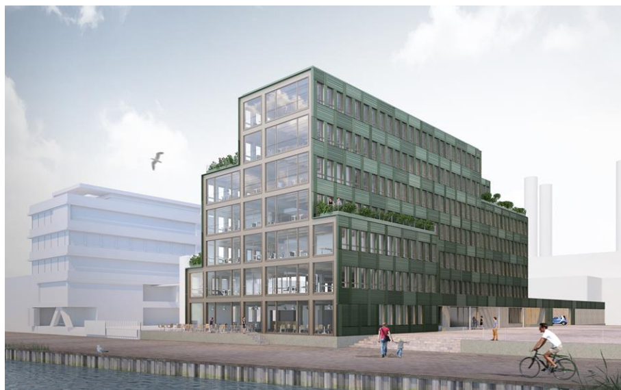
Abbildung 5: H7: Nach den Plänen des Architekten Andreas Heupel entsteht derzeit im Stadthafen Münster ein 7-geschossiges Büro- und Verwaltungsgebäude. Das H steht hierbei für die innovative Holz-Hybridbauweise. Die 7 für die realisierte Geschossanzahl. Damit handelt es sich um das höchste Gebäude dieser Art in NRW. Nach aktuell gültiger Landesbauordnung sind brennbare Baustoffe im Tragwerk nur bei Gebäuden mit max. drei Geschossen zugelassen. Mit einem hybriden Tragwerkskonzept – hier Holz in Verbindung mit Stahlbeton – konnte dieser Vorschrift jedoch intelligent Rechnung getragen werden.
