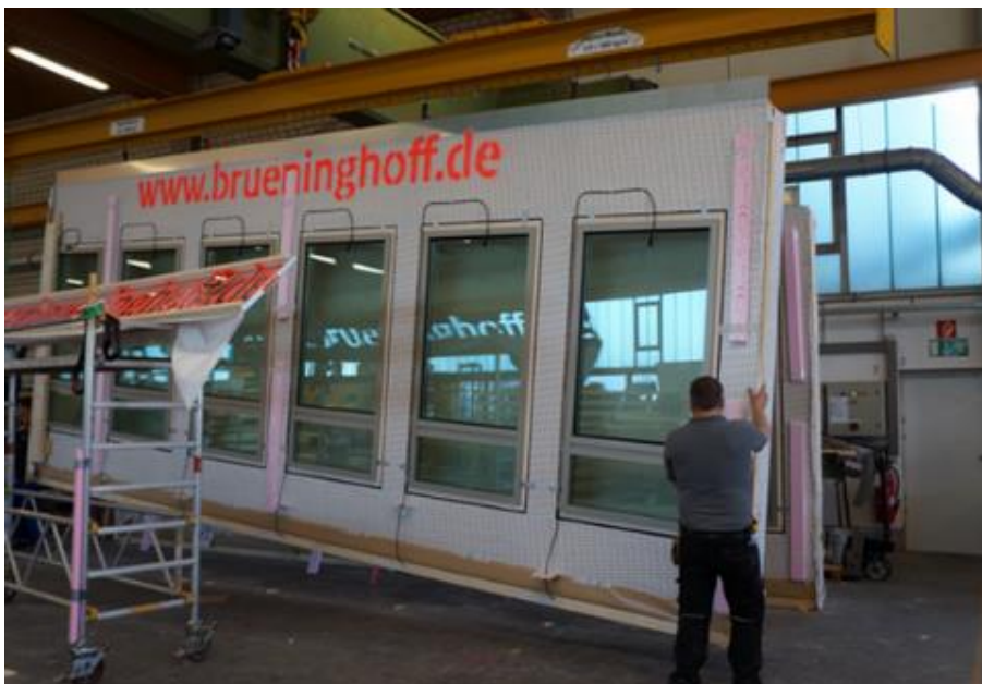
Abbildung 3: Bei der Vorfertigung verlagert sich der Herstellungsprozess eines Bauteils von der Baustelle in die Produktionshalle
