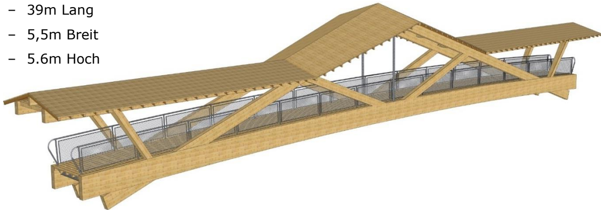
Abbildung 1: komplettes Cadwok Model welches alle Details und Verbindungen für den CNC Abbund enthält
