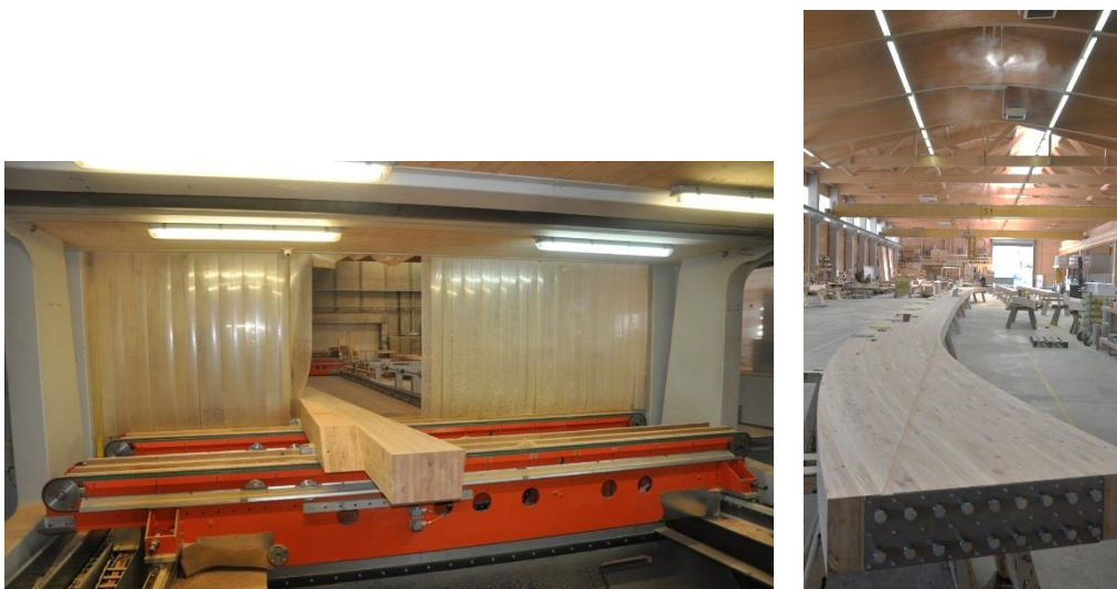
Abbildung 10: Abbund mit Schweizer Technowood Anlage, einkleben der Gewindestangen
