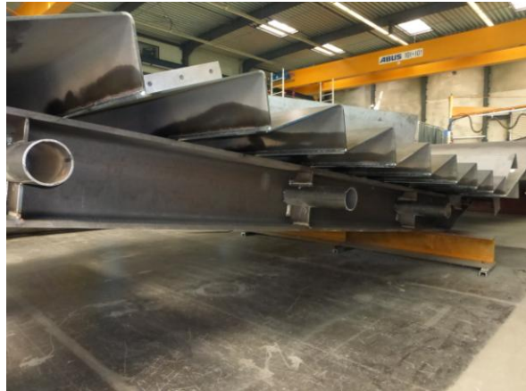
Abbildungen 8 und 9: Tragkonstruktion der Treppe und Stufen aus gekantetem Stahlblech. Quelle: Graf GmbH
