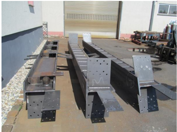
Abbildungen 6 und 7: Stoßträger mit Stützen Nebenbrücken und Stoßträger der Hauptbrücke. Quelle: Graf GmbH
