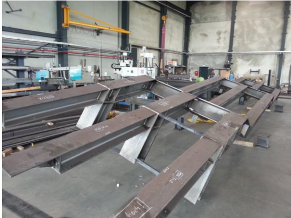
Abbildungen 8 und 9: Tragkonstruktion der Treppe und Stufen aus gekantetem Stahlblech. Quelle: Graf GmbH
