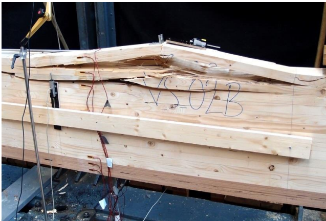
Abbildung 4: Bruchbild eines Hybridträgers mit 2 Verstärkungslamellen mit lokal ausgeknicktem Druckrand und vollständig intaktem Zugrand
