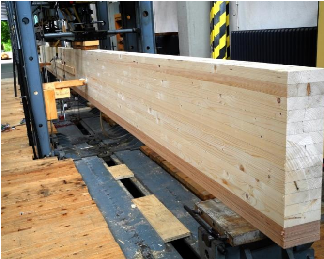
Abbildung 3: Ansicht des Prüfaufbaus für das Beispiel eines Trägers mit 2 Buchen-Furnierschichtholzlamellen
