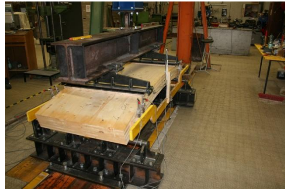
Abbildung 6: Eingebauter Schubversuch eines 9-schichtigen einfach gekrümmten Brettsperrholzelements
