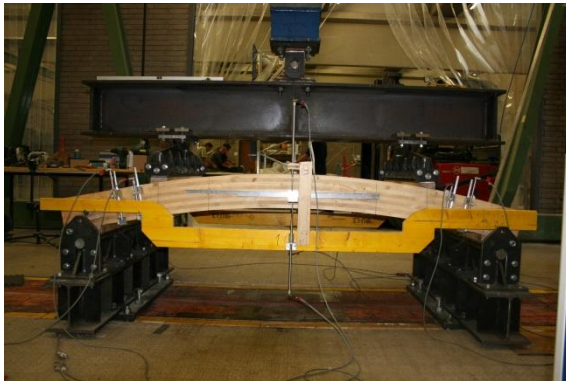
Abbildung 6: Eingebauter Schubversuch eines 9-schichtigen einfach gekrümmten Brettsperrholzelements
