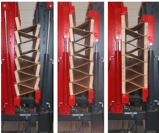
Abbildung 17: Pressvorgang von beleimten und gestapelten Ober- und Untergurtlagen.
