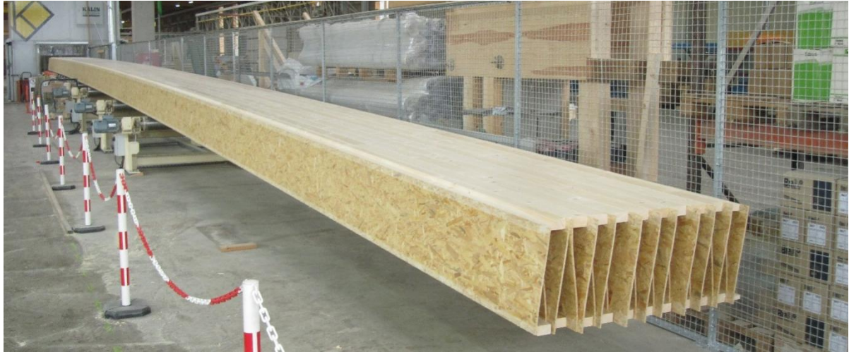
Abbildung 25: Zeigt ein gekrümmtes Kielstegelement nach der Hobelung.
