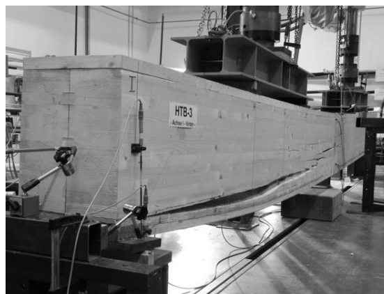
Abbildung 13: Schubversagen im Brettschichtholz und Furnierschichtholz, hier: HTB-3
