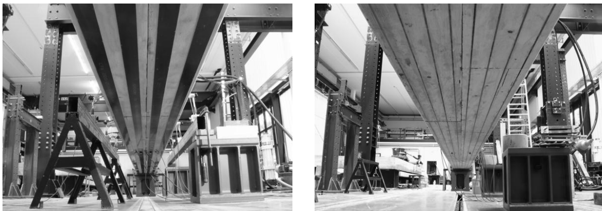
Abbildung 4: Zugzonenverstärkung mit CFK-Lamellen; Links: HTB-1, Rechts: HTB-2
