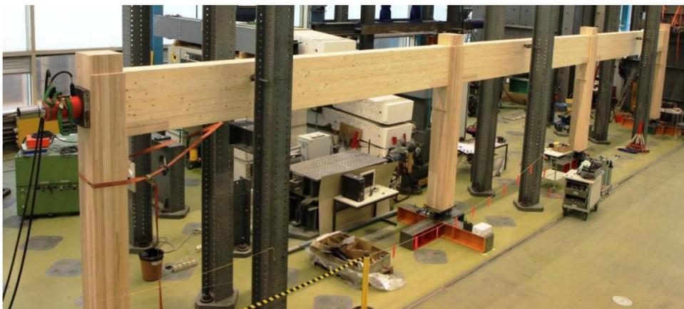
Abbildung 3: Pushover-Versuche an einem vorgespannten BSH Träger mit 3 Feldern auf dem Ausspannboden der HIF Bauhalle an der ETH Zürich Höggerberg
