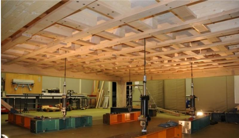
Abbildung 8: Experimentelle Untersuchungen an einem kompletten Deckenelement (6.5x6.5m) der entwickelten zweiachsig lastabtragenden Holzdecke aus Laubholz
