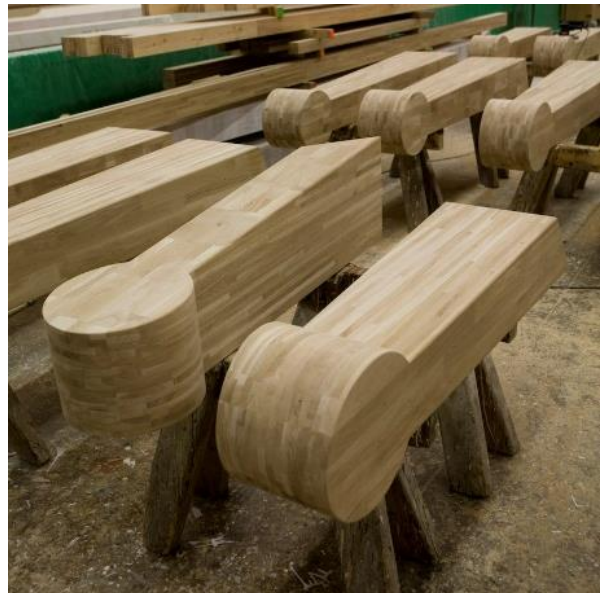
Abbildung 2: Weingut in Italien, Nebenträger aus Blockverleimter Eiche.
