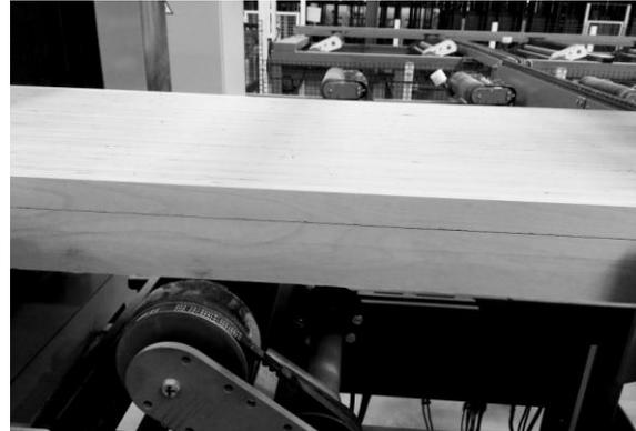
Abbildung 14: Auftrennen der BauBuche-Träger zur BauBuche Paneel
