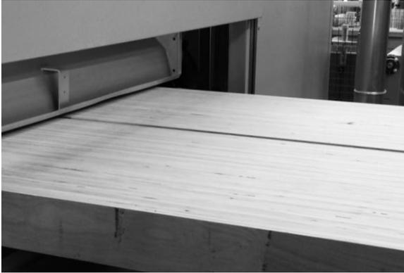
Abbildung 13: Träger BauBuche GL 70 beim Auslauf aus der Schleifmaschine
