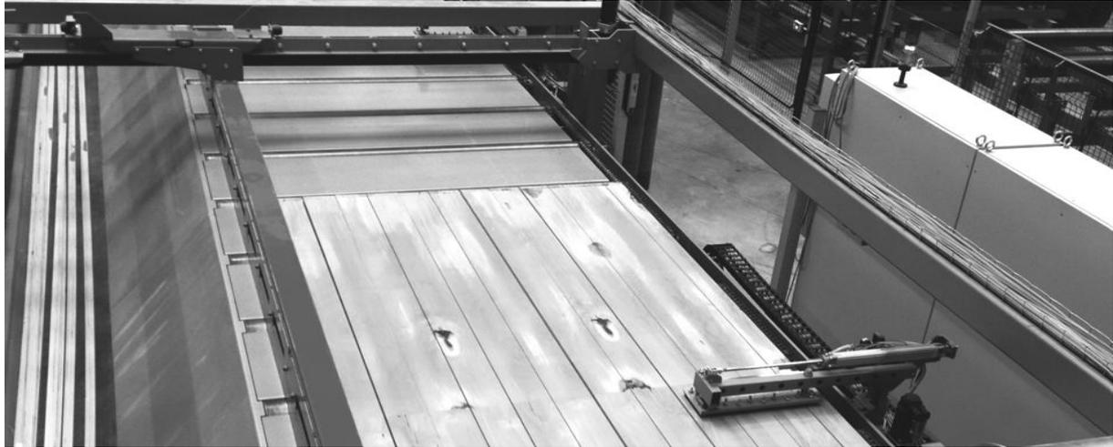
Abbildung 8: ungeschliffene BauBuche Lamellen
