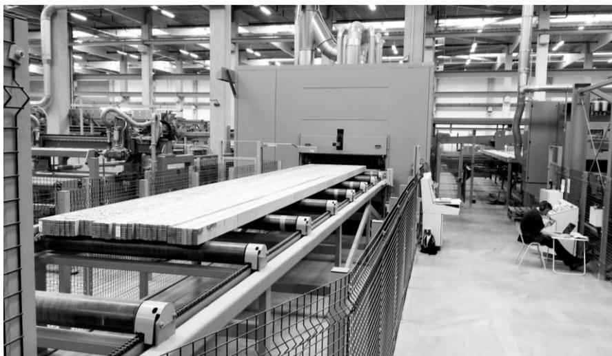
Abbildung 12: Träger BauBuche GL 70 beim Einlauf in die Schleifmaschine
