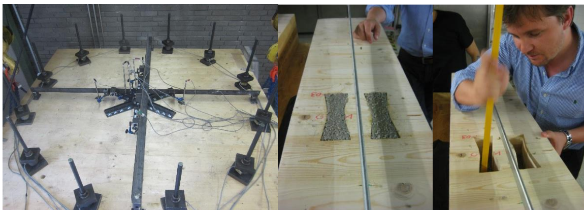
Abbildung 6: SPIDER-CONNECTOR-SYSTEM: Versuchssetup Auflagerung Stütze und Ausführung Plattenstoß mittels Reaktionsharz
