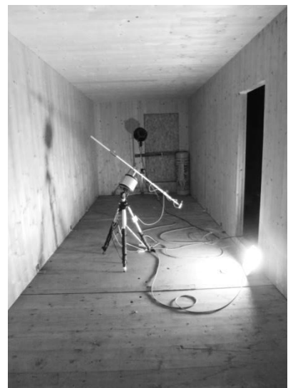
Abbildung 5: Messung und Berechnung der Körperschallübertragung über einen T-Stoß (oben links) unter Verwendung der Finite Elemente Methode (oben rechts); Vergleich der gemessenen und berechneten Schnellepegeldifferenzen (unten)
