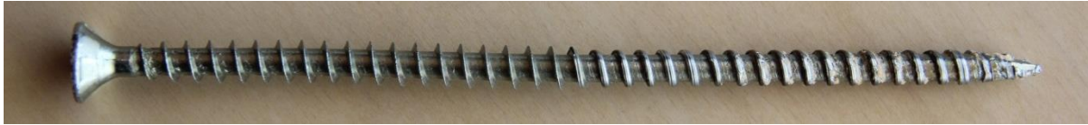
Abbildung 5: Vollgewindeschraube mit beschädigtem Gewinde auf der Seite der Spitze
