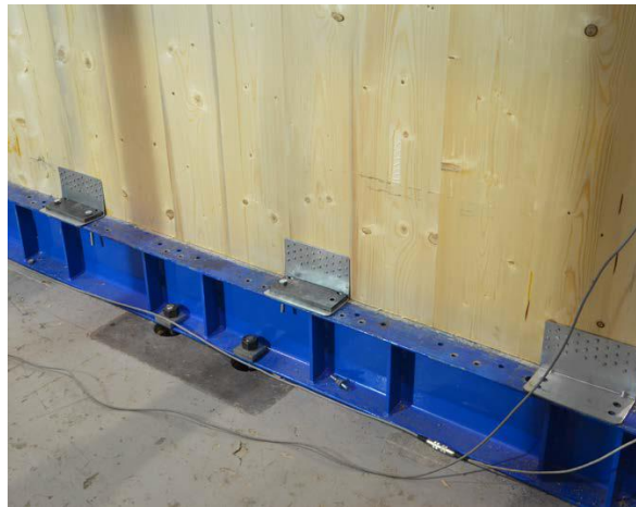
Abbildung 7: Detailansicht der Verbindungsmittel TITAN
