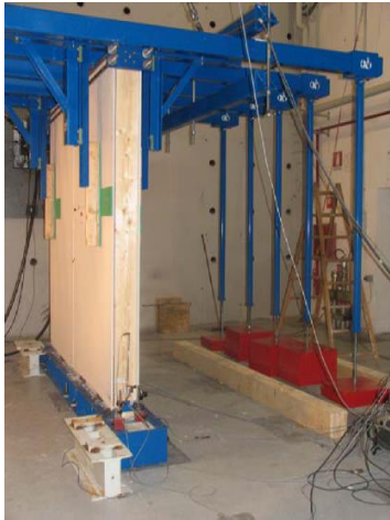
Abbildung 6: Versuchseinrichtung zum Testen von Holzwänden in Echtgröße.
