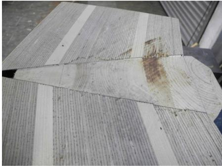
Abbildung 19: Ansicht eines untersuchten LVL-Kompositaufbaus
