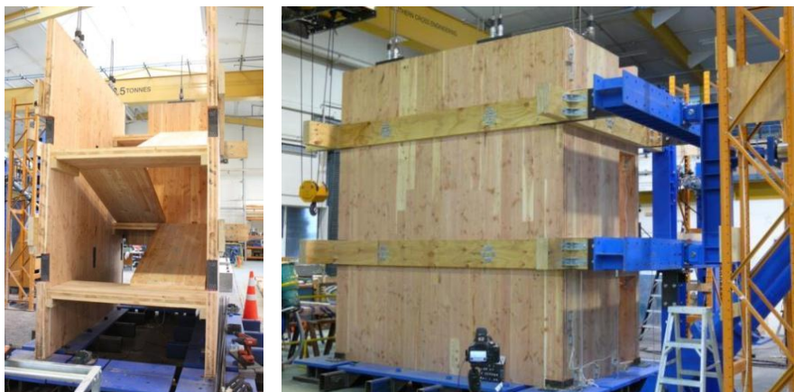
Abbildung 10: Treppenaufgang aus vorgespanntem Brettsperrholz.
