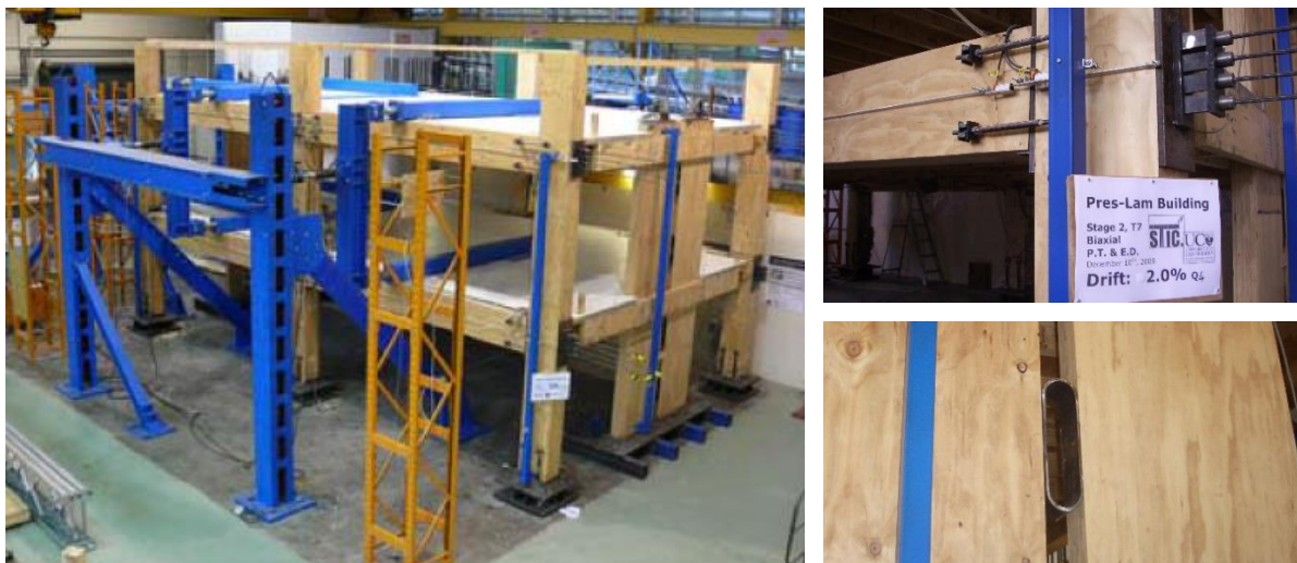
Abbildung 7: Versuchsaufbau eines Pres-Lam Gebäudes (links) mit Träger-Stütze-Knotenpunkt (rechts oben) und gekoppelten Wänden (rechts unten).
