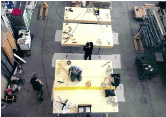
Abbildung 22: Verklebung der CLT-Elemente für die Grossbrandprüfung
