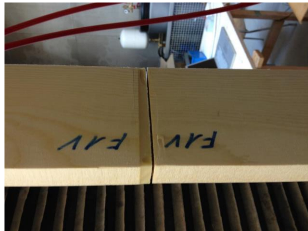
Abbildung 14: Stumpf verklebter Stoss in der Zugprüfanlage [6]
