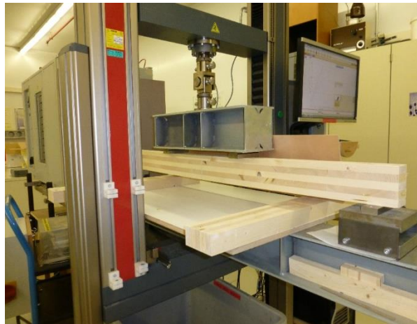
Abbildung 20: Prüfanordnung für Biegeprüfungen an CLT-Trägern
