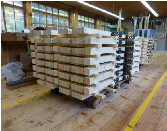
Abbildung 19: Langzeit-Biegeversuche an CLT-Trägern mit verklebter Stoßfuge in der Mitte
