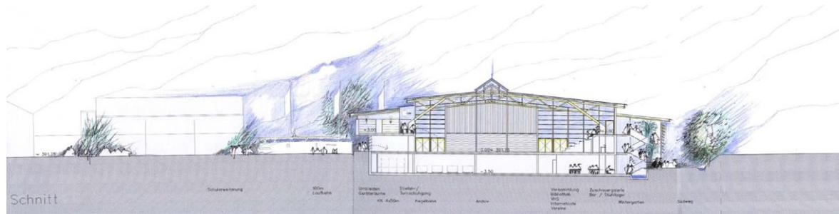
Abbildung 11: Querschnitt mit Tiefhof und Fluchtbalkon im OG
