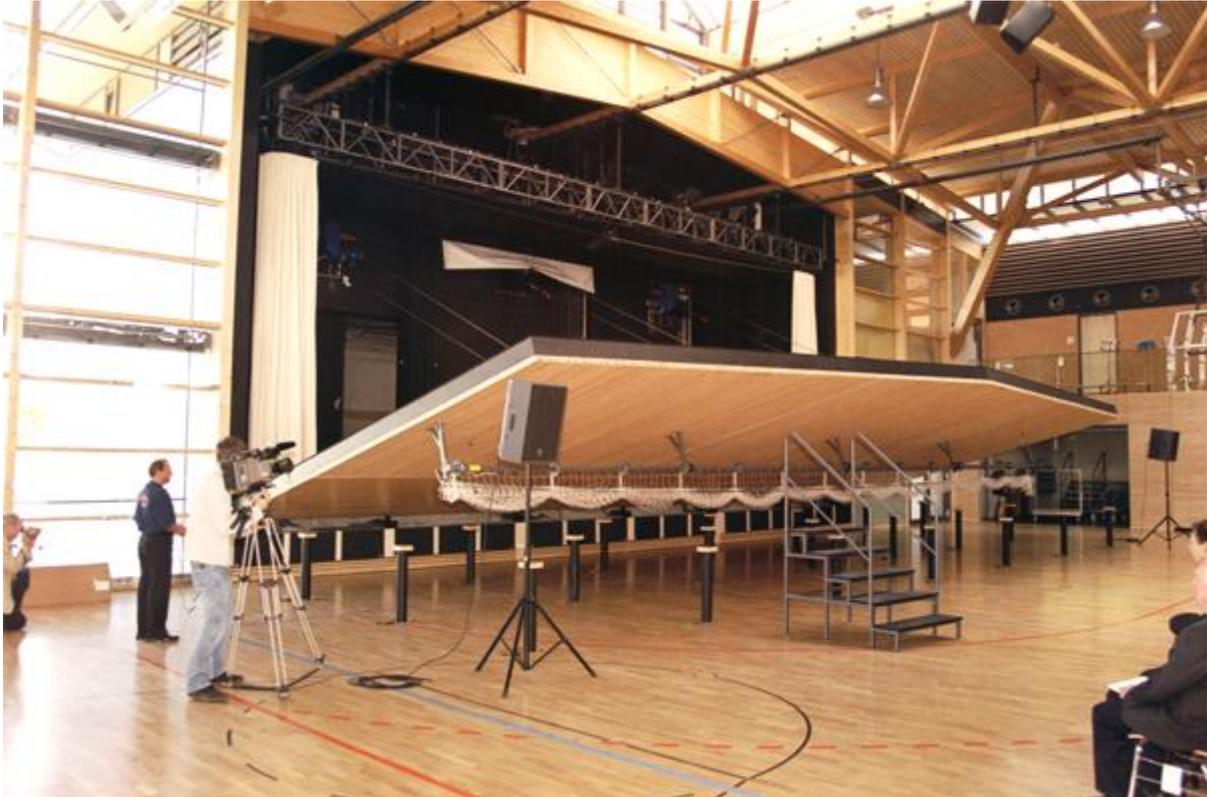
Abbildung 1: Klappbühne beim Öffnen
