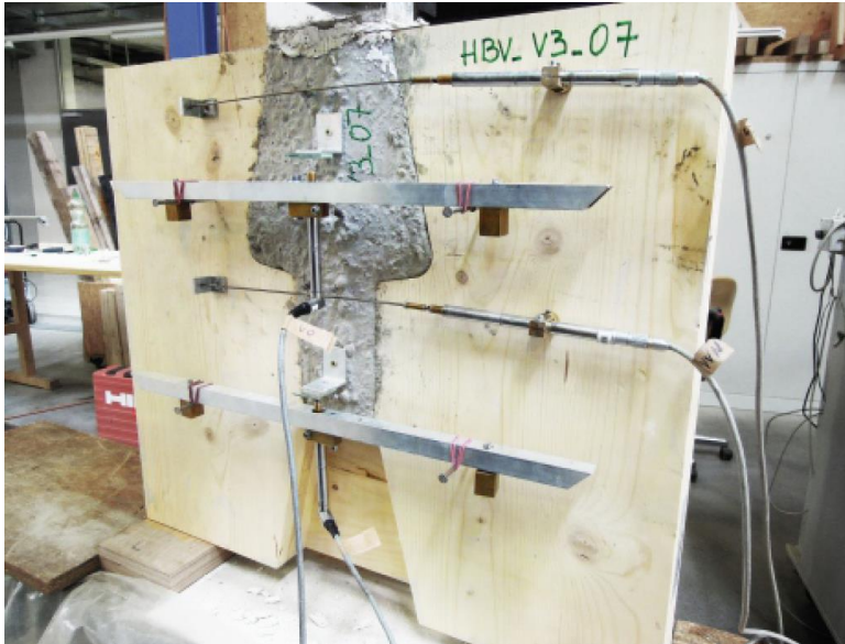
Abbildung 5: Prüfanordnung zur Prüfung der tropfenförmigen Betonkonsolen [4]
