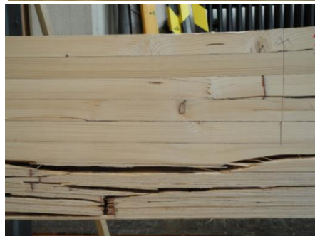
Abbildung 3: Typisches Beispiel für die Lastverschiebungskurve (a) und die Bruchbilder eines zunächst in der Druckzone geschädigten Verbundträgers (b), der schließlich im Biegezug-Modus versagt (c); FSH-Anteil 25%, Holzart Birke, mit Keilzinken
