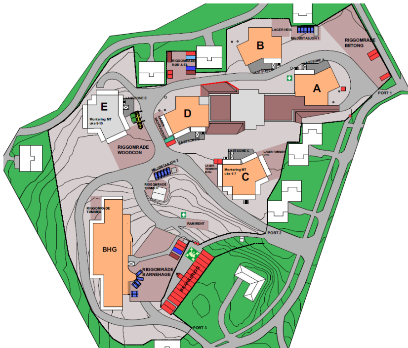
Abbildung 6: Baustellenplan (Ausschnitt) [Veidkke/Woodcon AS]
