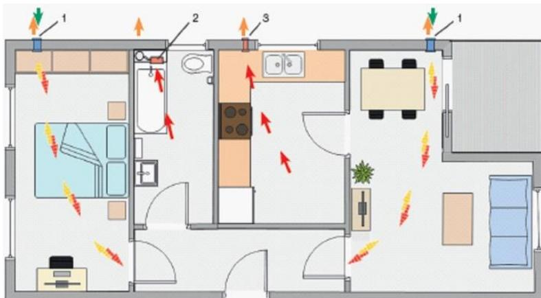
Abbildung 2: Dezentrale Lüftungsgeräte in einer Zweizimmerwohnung. Quelle: [www.maico-ventilatoren.de](http://www.maico-ventilatoren.de)
