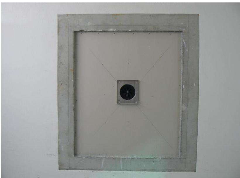
Abbildung 3: Dezentrales Lüftungsgerät im Fensterprüfstand der HFT Stuttgart.
