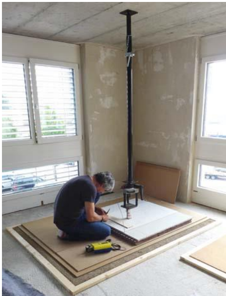
Abbildung 10: Versuchsanordnung Deformationsmessungen; Punktbelastung auf Estrichsystemen (Abbildung links), Flächenbelastung auf Kalksplitt (Abbildung rechts) [10]
