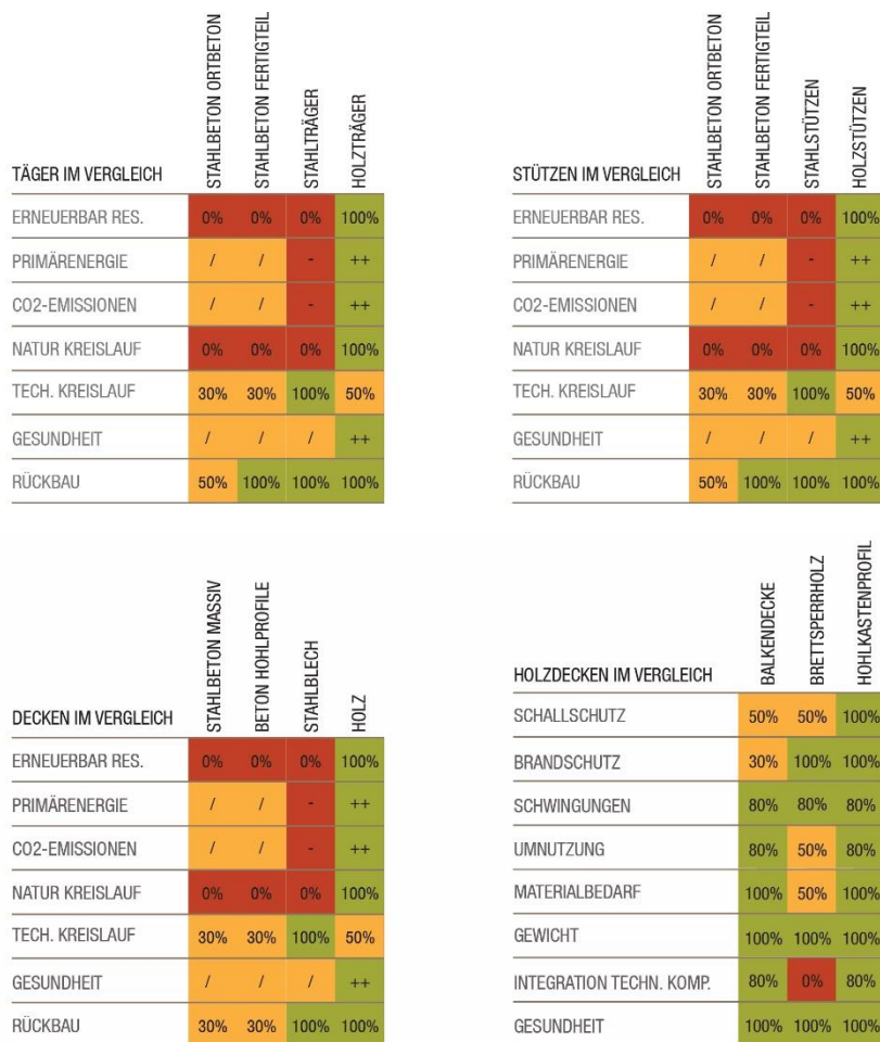
Abbildung 5: Material- und Konstruktionsvergleich tragender Bauteile
