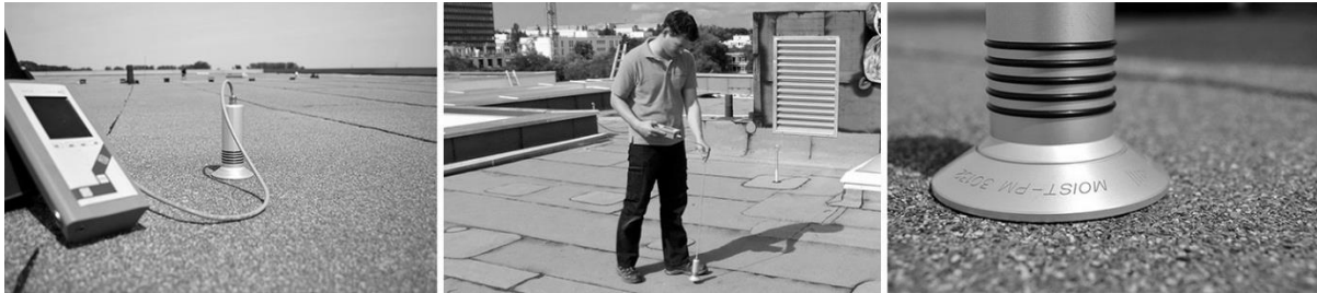
Abbildung 9: Leckageortung mittels Mikrowellenverfahren; Quelle: FLO Leckortung
