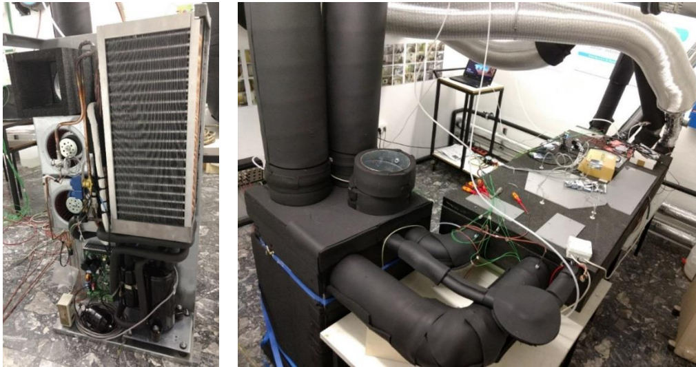
Abbildung 4: (links) Außeneinheit beim Einbau, (rechts) Gesamtaufbau Funktionsmuster mit Innen- und Außeneinheit im Kompaktgeräteprüfstand der UIBK (Siko Energiesysteme)
