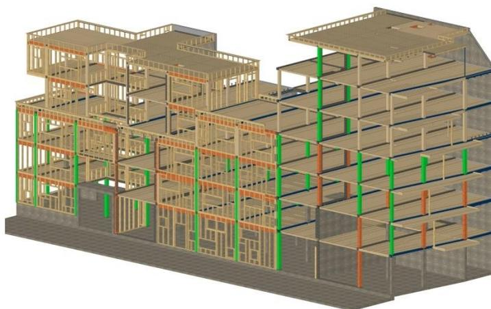
Abb.19: C13 in Skelettbauweise mit Unterzug-Stützenkonstruktion und nichttragenden Aussenwänden in Rahmenbauweise (5-geschossigen Teil) und in Brettsperrholzbauweise (7-geschossiger Teil).
