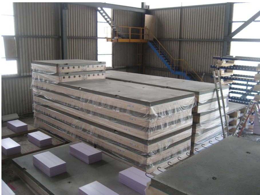
Abbildung 12: Vorgefertigte Deckenelemente (Bildquelle: ERNE AG)
