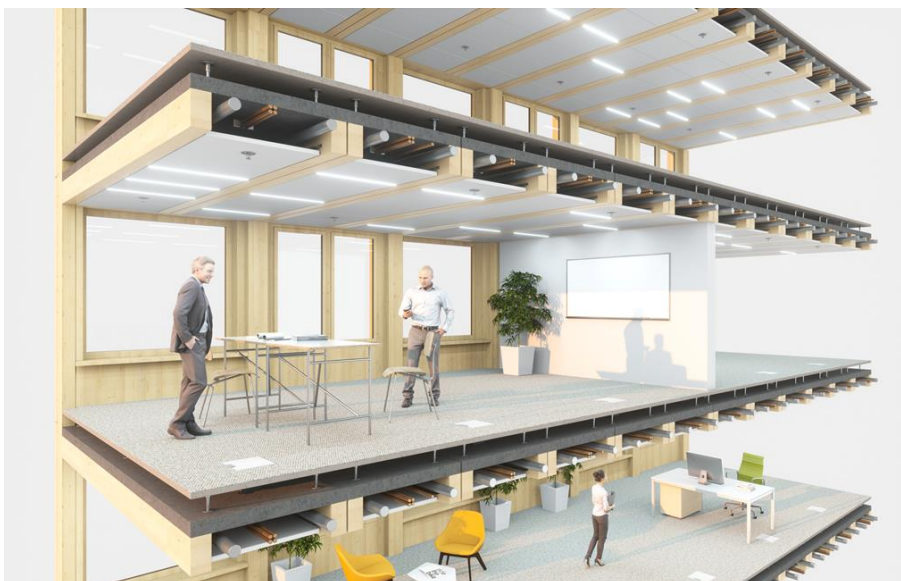
Abbildung 11: Suprafloor ecoboost 2 : Heizen und Kühlen unter Einbezug der Betonmasse (Bildquelle: ERNE AG)
