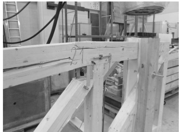
Abbildung 16: Fachwerkträger (Typ 1) nach dem Versagen
