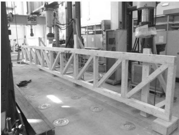
Abbildung 15: Fachwerkträger (Typ1) beim Versuchsaufbau
