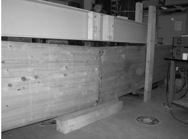
Abbildung 3: Biegeträger mit Vollstoß im Versuchsstand
