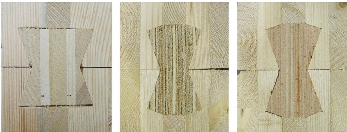
Abbildung 4: Keilmaterialien. Links: Fichtensperrholz; Mitte: Furnierschichtholz KERTO-Q; Rechts: Buchenfurniersperrholz.
