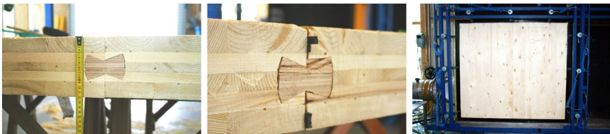
Abbildung 12: Links: Verbindung mit einem Einbauspiel von 1 mm; Mitte: Anordnung der Fugendichtbänder am Prüfkörper mit einem Luftzwischenraum zwischen den Koppelleisten und der Keilnut; Rechts: im Prüfstand eingebauter Prüfkörper.
