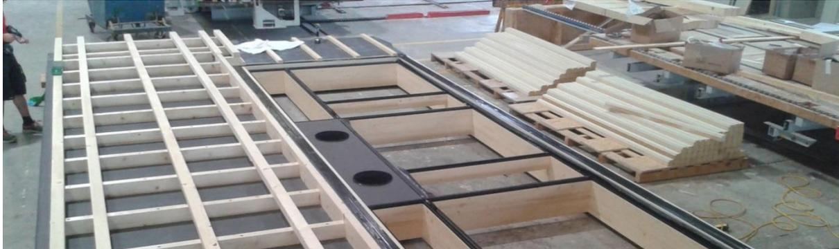
Abbildung 4: Vorfertigung mit integrierter Pfosten-Riegel-Fassade
