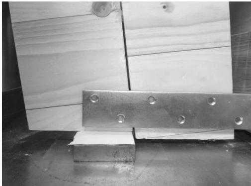
Abbildung 9: Typisches Versagensbild der Prüfkörper am Beispiel HSK-Roll 02
