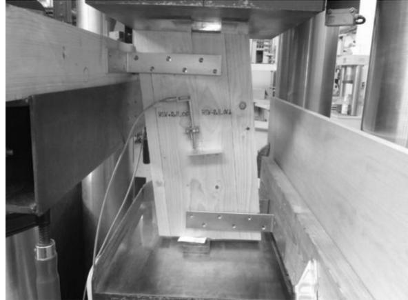
Abbildung 8: Eingebauter Druckscherprüfkörper mit Kipphalterung
