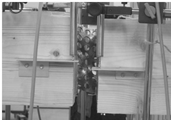
Abbildung 14: Verbindung während dem Versuch, Ausbildung von Beulfeldern
