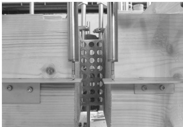
Abbildung 13: Seitenansicht der Verbindung mit Wegaufnehmern
