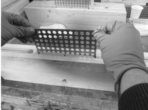
Abbildung 7: Einkleben des Lochblechs im Bereich zwischen den Bohrungen  $\varnothing$  20 mm
