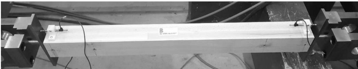
Abbildung 3: Eingespannter Prüfkörper parallel zur Faser als Zug-Zug-Versuch
