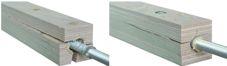
Abbildung 6: Aufspalten eines Querschnitts ohne Querbewehrung (links) und behindertes Aufspalten eines Querschnitts mit Querbewehrung beim Scherversagen der Klebefuge (rechts)
