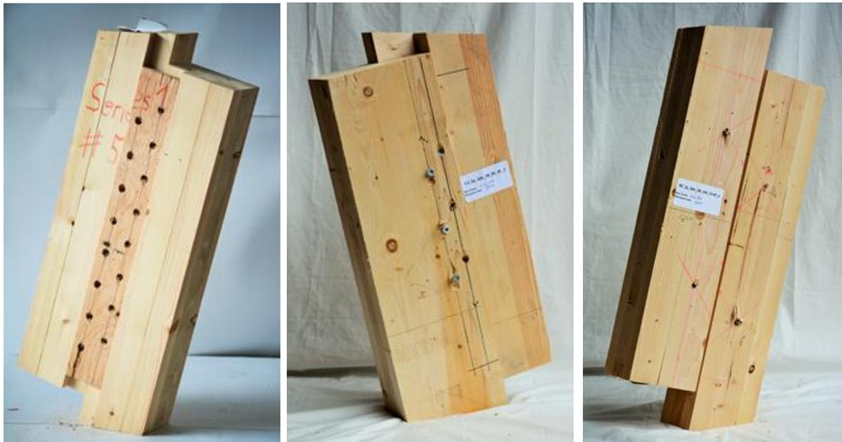
Abbildung 2: Versuchskörper: Spline-Joint (links) Lap-Joint (Mitte) Butt-Joint (rechts)
