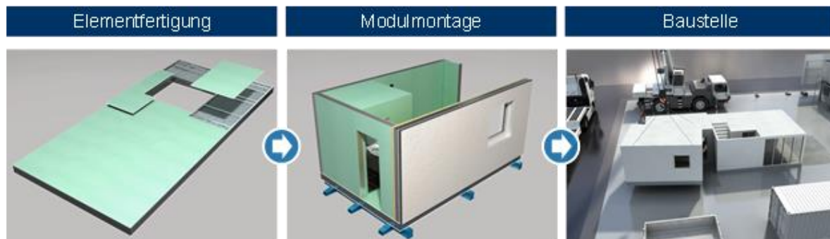
Abbildung 1: Produktionsprozess im modularen Hausbau
