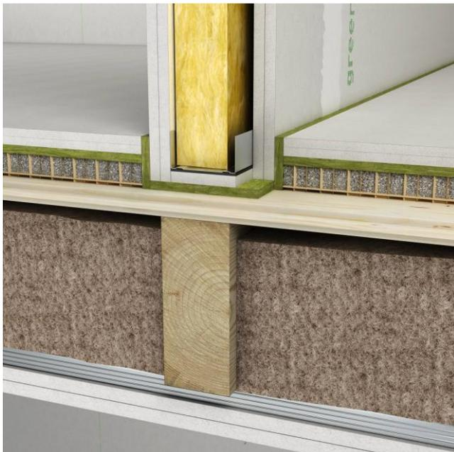
Abbildung 4: Beispiel – Anschluss Trockenbauwand (F90-A auf Holzbalkendecke F90-B)
