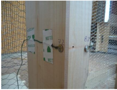
Abbildung 5: Detailaufnahme – Lage der Thermoelemente an der Stirn- und Längsseite
