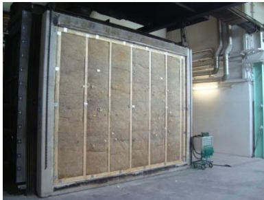
Abbildung 15: nach 47 Minuten beginnende Braunverfärbung bei Probekörperhälfte WA2
