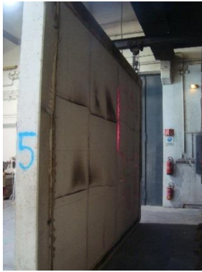
Abbildung 18: Unmittelbar nach Prüfe - wenige Risse in Gipsfaserplatte - WA1
