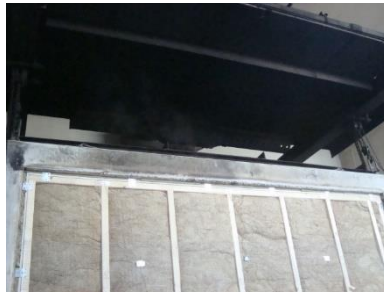
Abbildung 13: Nach 11 Minuten Rauchaustritt zwischen Probekörper und Prüfrahmen
