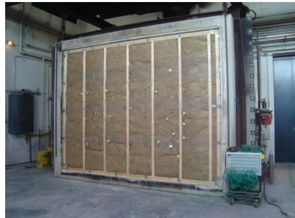
Abbildung 11: Ansicht Prüfofen mit Probekörper
