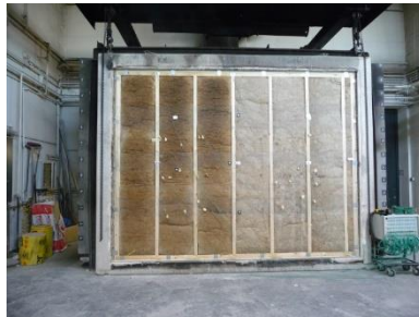
Abbildung 16: nach 70 Minuten ausgeprägte Braunverfärbung der Mineralwolle bei der Probekörperhälfte WA2
