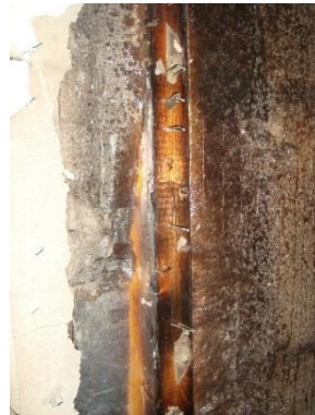
Abbildung 22: WA1 - Ansicht Steher hinter doppelter Beplankung - 26 Minuten nach Prüfe
