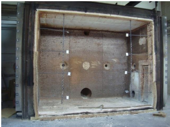
Abbildung 10: Ansicht Prüfofen ohne Probekörper
