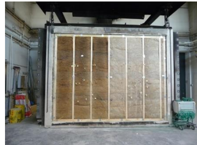
Abbildung 17: Ansicht Probekörper bei Prüfende (90 Minuten), links- WA2-einfache Beplankung, rechts- WA1-doppelte Beplankung
