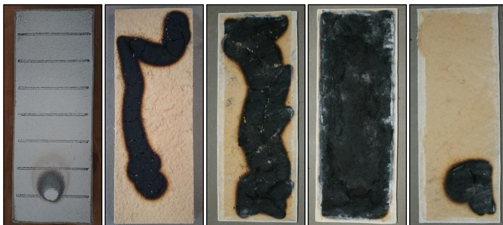
Abbildung 3: verputzter Probekörper nach der Beflammung (links), sowie typische Schwelverläufe nach Versuchsende in Holzfaserdämmstoffmitte
