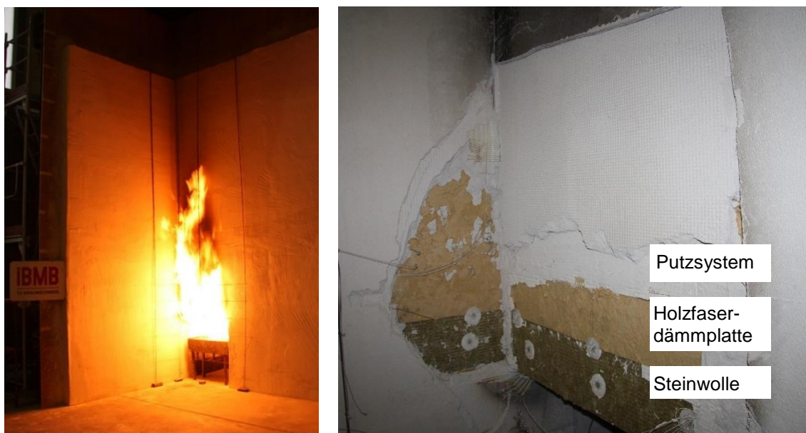
Abbildung 5: Holzfaser-WDVS während der Beflammung im Fassadenprüfstand (links); nach Versuchsende geöffnetes System mit ungeschädigtem Holzfaserdämmstoff im Bereich über der Brandraumöffnung (rechts)
