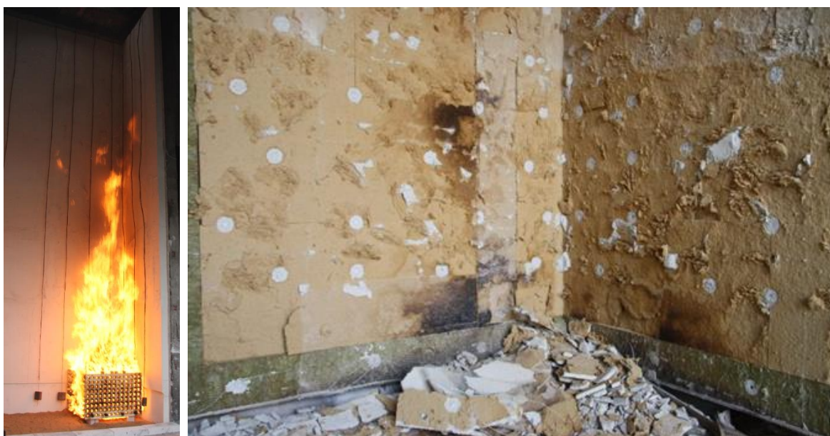
Abbildung 6: Holzfaser-WDVS während der Beflammung im Sockelbrandversuch (links); Nach Versuchsende geöffnetes System im Sockelbrandversuch, mit leichten Verfärbungen im Bereich der Holzkrippe (rechts)
