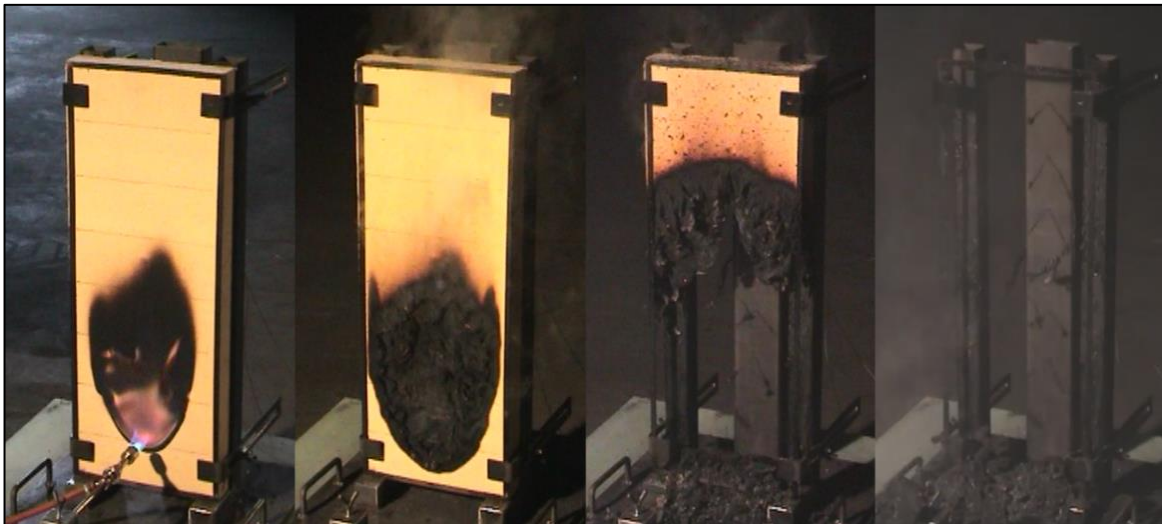
Abbildung 2: Verlauf einer Schwelprüfung nach DIN EN 16733 mit Holzfaserdämmplatten (v.l.n.r.) während der Beflammung, unmittelbar danach, sowie zwei und sechs Stunden nach der Beflammung
