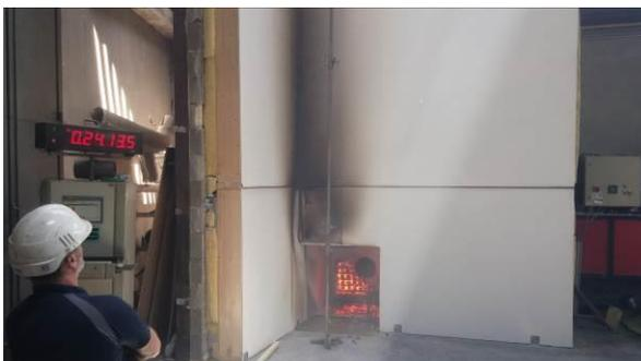
g) 24'14'': Geringe Schäden an Fassade sind erkennbar.
