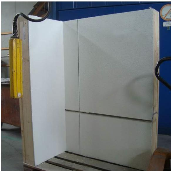
Abbildung 7: Prüfkörper für den SBI Test
