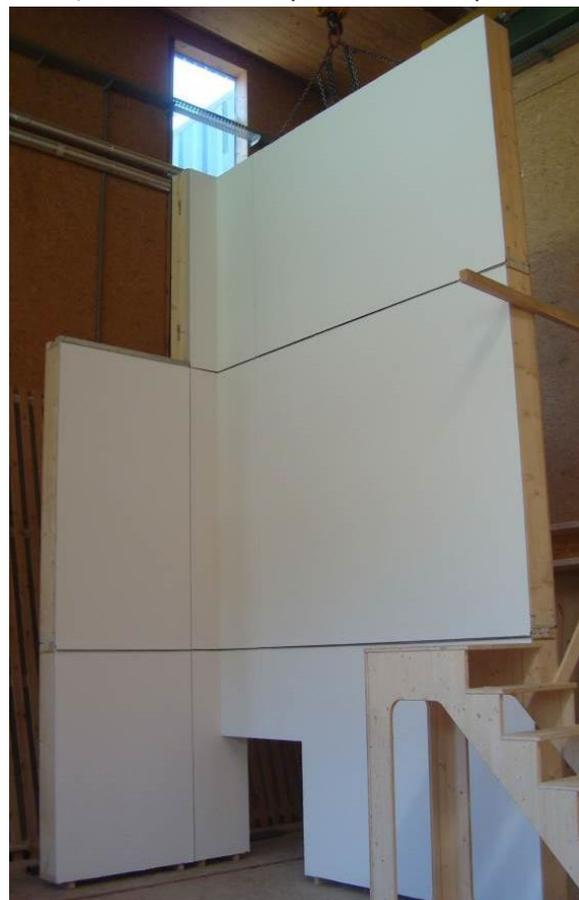
Abbildung 3: „low-cost prefab façade“ für den Großbrandversuch nach ÖNORM B 3800-5
