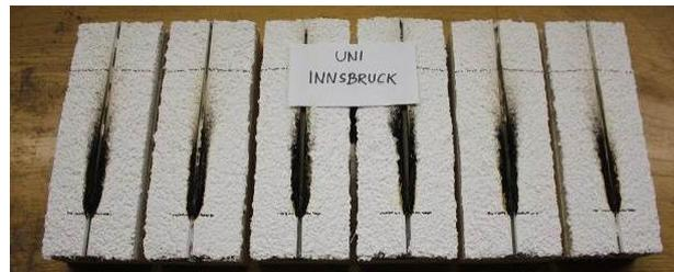
Abbildung 10: Small Flame Test – mit Fuge – nach erfolgtem Versuch
