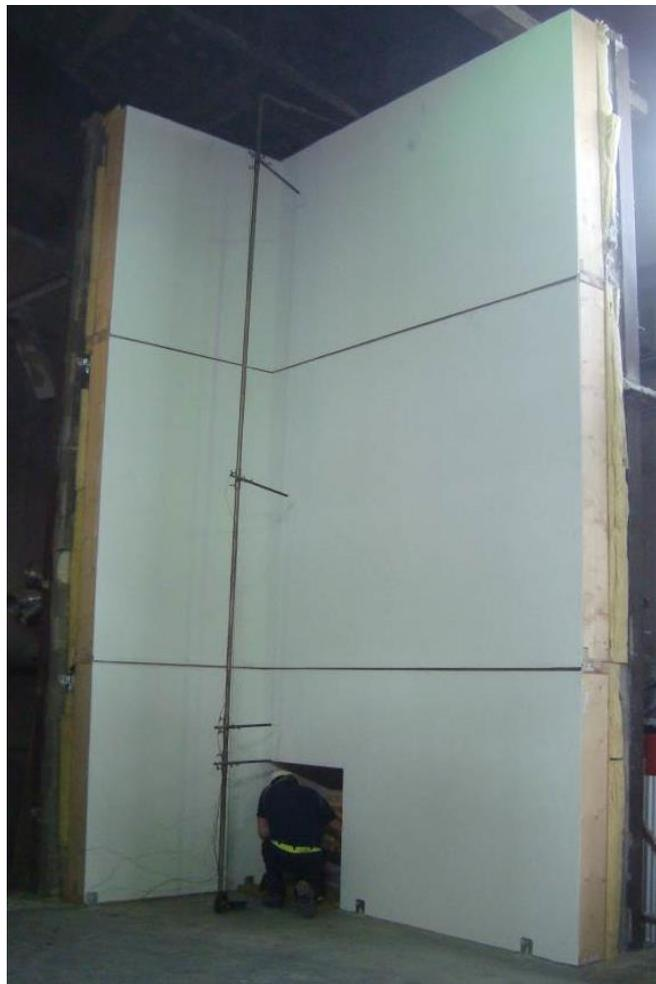
Abbildung 11: Entzünden der Holzkippe beim Fassadengroßbrandversuch nach ÖNORM B 3800-5
