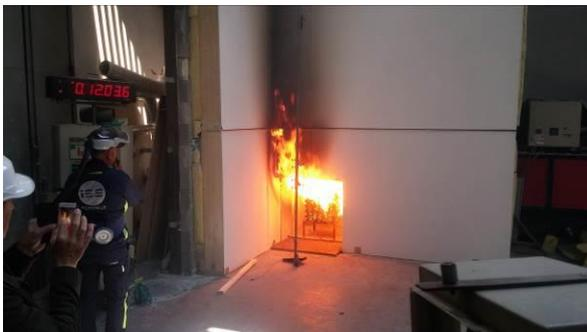
e) 12'04'': max. Temperaturdifferenz über Sturz  $\Delta T = 921 \text{ K}$
