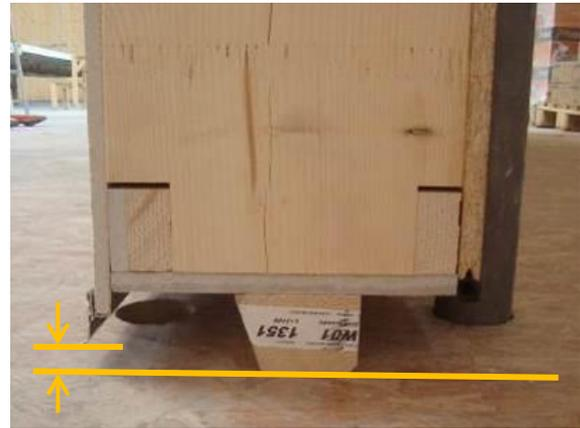
Abbildung 5: Detail der Horizontalfuge | Putzprofil durch Schwelle geometrisch geschützt (dargestellt an einem mittleren Prüfkörper des Großbrandversuchs | vgl. Kapitel 3.2)
