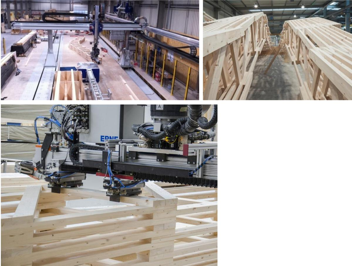
Abbildung 16: Herstellung der Träger mittels Portalroboter
