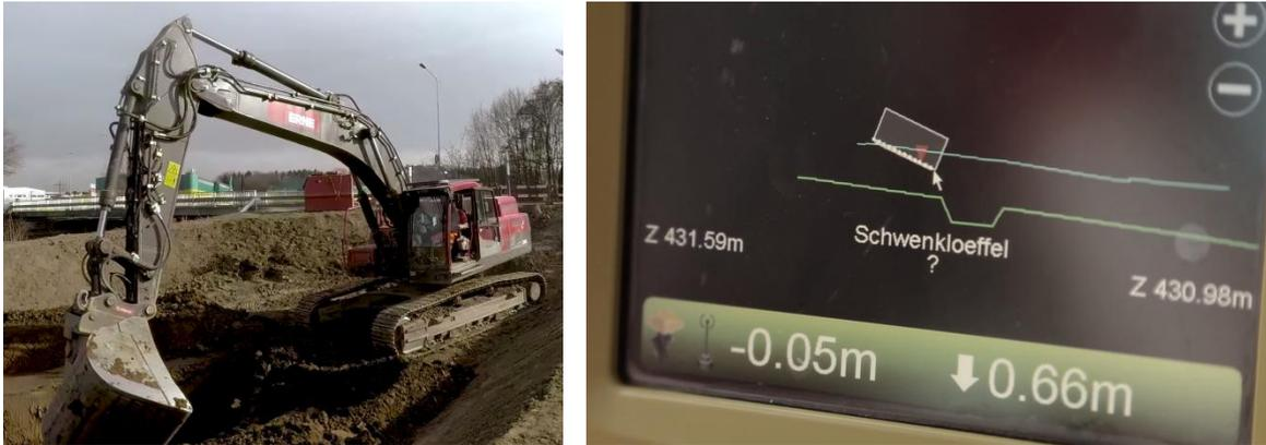
Abbildung 7: Bagger, der mittels digitalen Daten angesteuert wird.
