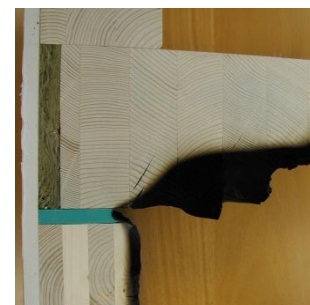
Abbildung 4: Detail nach Brandversuch, HFA
