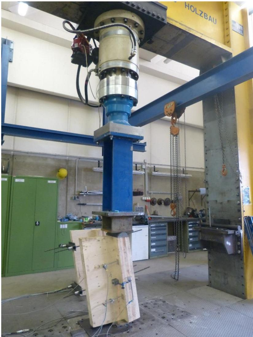
Abbildung 2: Prüfkörper eingespannt in der Prüfmaschine der der Technischen Versuchs- und Forschungsanstalt der Universität Innsbruck.
