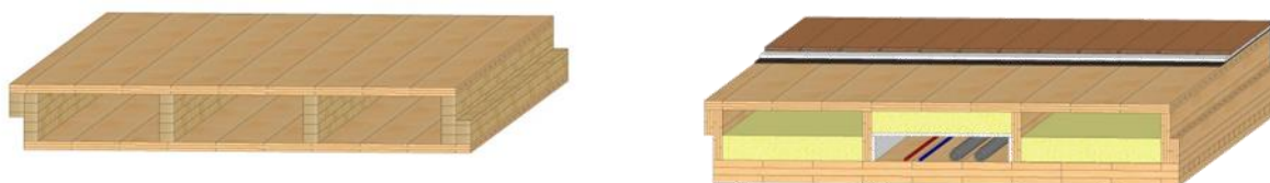
Illustration 3 : Un exemple d'utilisation du CLT-C de Lineazen : le plancher
