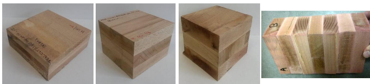
Illustration 9 : Résultats des essais de délamination sur du CLT Lineazen 3(12), 3(24), 3(30) et 7(30)
