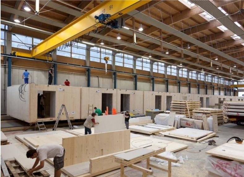
Abbildung 2: Vorfertigung der Module in Kalwang (© Andrew Phelps)
