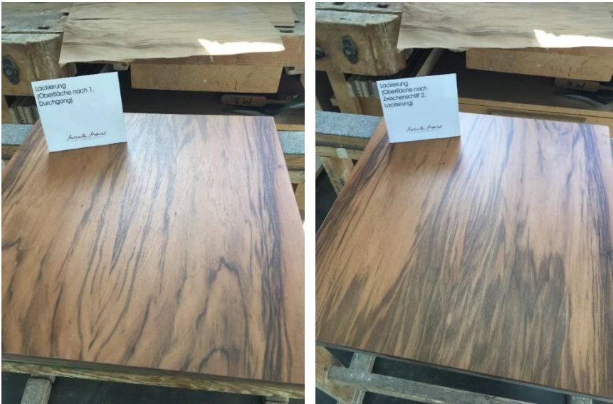
Abbildung 10a/b: In zwei Durchgängen wird die furnierte Platte geschliffen und lackiert oder geölt. Das Furnier «feuert» dadurch an, das heißt die Farben werden intensiver.
