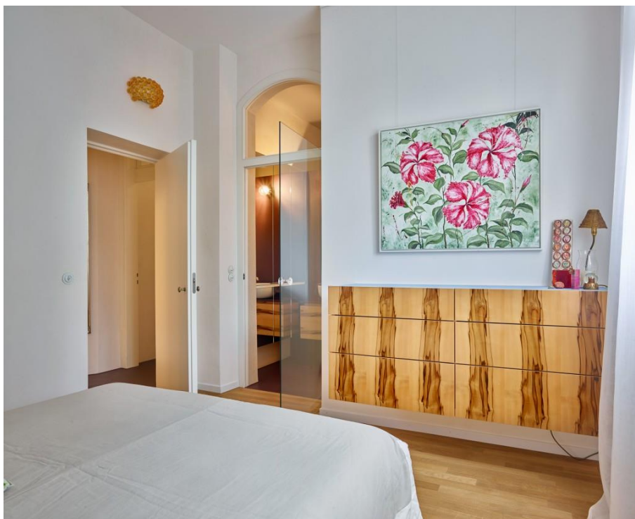
Abbildung 14: Senkrechte Ausrichtung des Furniers
