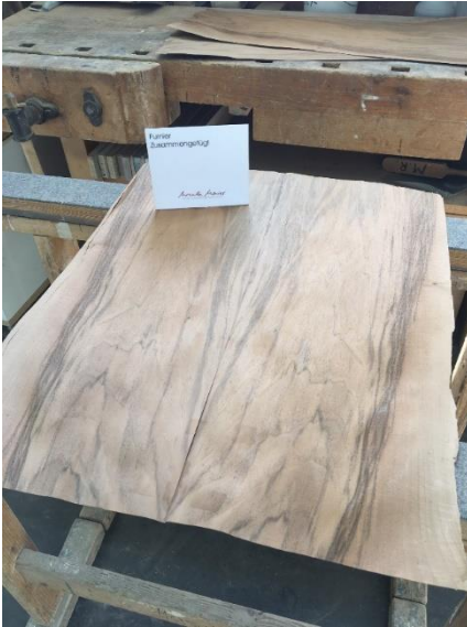
Abbildung 7: Das zugeschnittene Furnier wird an seinen schmalen Kanten gefügt. Es ist ein Qualitätsmerkmal, wenn das Furnier nicht an der breiten Seite mit einem Leimfaden vernäht ist, sondern an der schmalen Kante zusammenhängend geklebt ist. Dazu bedarf es einer besonderen Maschine, der Furnierfügemaschine.
