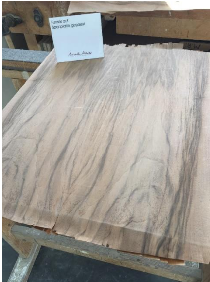
Abbildung 8a/b: Das Furnier wird mit einer Furnierpresse (eine Art riesengroßes doppelseitiges Bügeleisen) unter Druck und Wärme auf die Trägerplatte geklebt.
