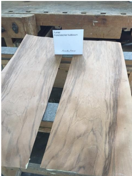
Abbildung 5: Das rohe Furnier (in diesem Fall französischer Nussbaum) wird auf das benötigte Format zugeschnitten.
