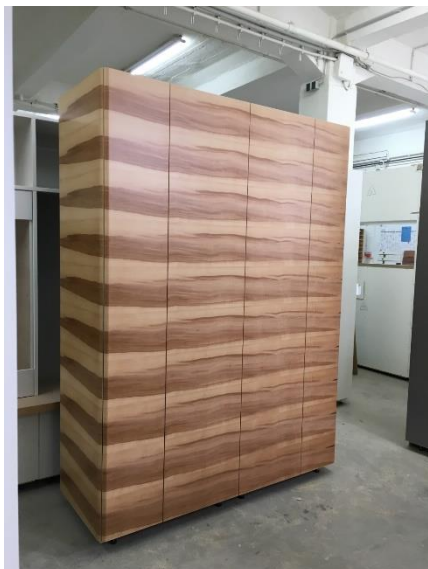
Abbildung 19: Eine unserer absoluten Alleinstellungsmerkmale. Runde Kanten, auf denen das Furnier durchläuft.
