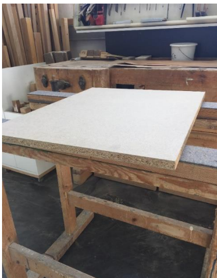
Abbildung 6: Die Trägerplatte – je nach Bedarf eine Mehrschicht-, Leichtbau-, Tischler-, mdf-Platte etc.
