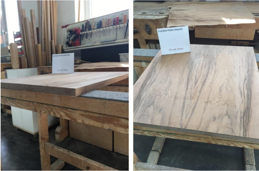
Abbildung 9a/b: Die überstehenden Furnierkanten werden abgeschnitten und es kommt eine Echtholz furnierkante auf die schmalen Seiten.
