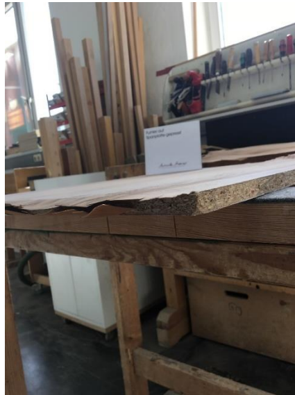
Abbildung 8a/b: Das Furnier wird mit einer Furnierpresse (eine Art riesengroßes doppelseitiges Bügeleisen) unter Druck und Wärme auf die Trägerplatte geklebt.
