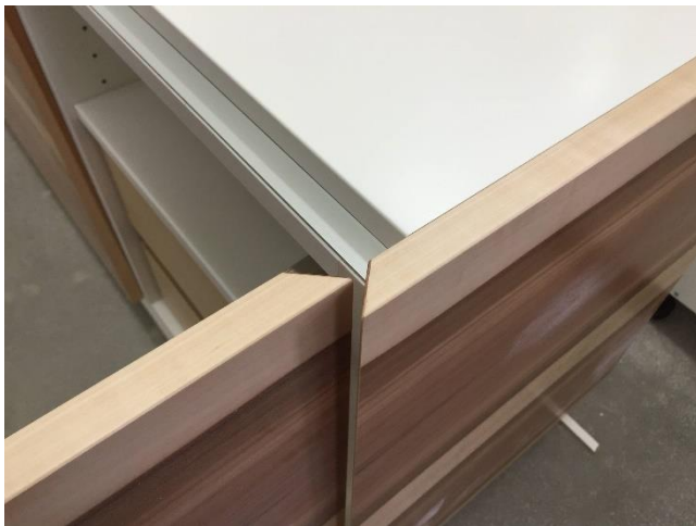
Abbildung 18: Detail für ein auf Gehrung umlaufendes Furnier
