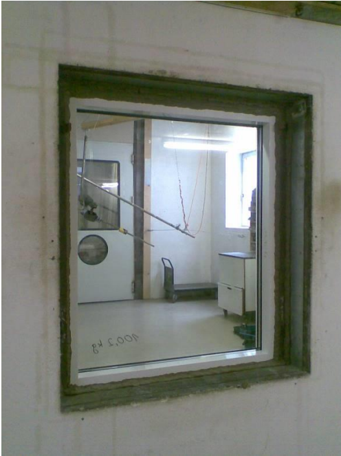
Abbildung 2: Beispiel für ein Fassaden-Festfeldelement im Normformat, eingebaut in den Fensterprüfstand nach DIN EN ISO 10140
