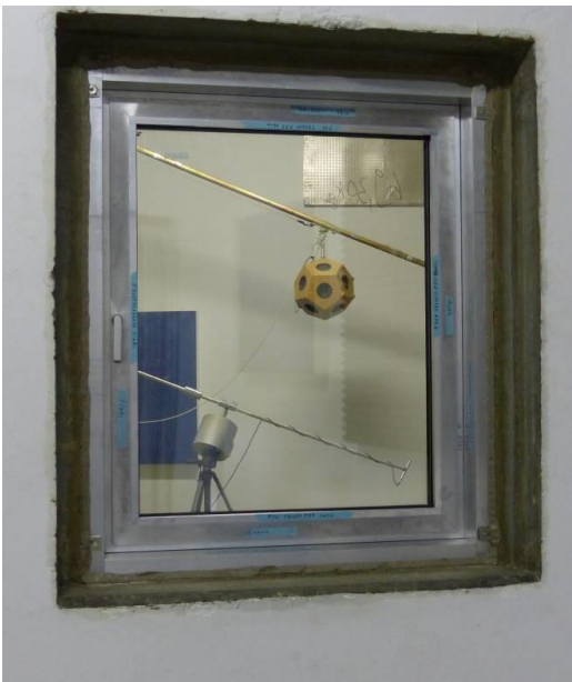
Abbildung 3: Beispiel für ein Einsetzelement in einem Fassadenrahmen im Normformat, eingebaut in den Fensterprüfstand nach DIN EN ISO 10140
