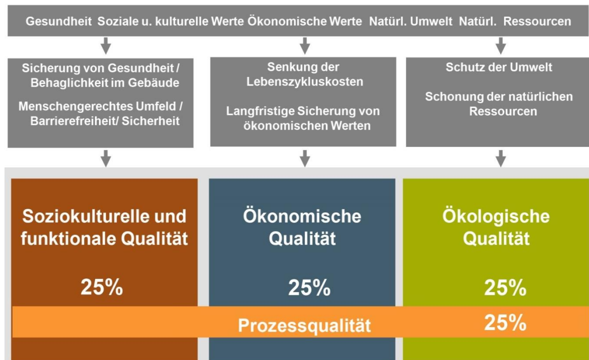
Abbildung 3: Methodik und Aufbau des Bewertungssystems für kleine Wohngebäude (BNK)
