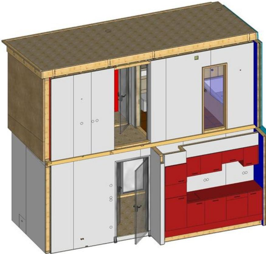
Abbildung 4: 3D-Konstruktion Module. Quelle: IETC GmbH
